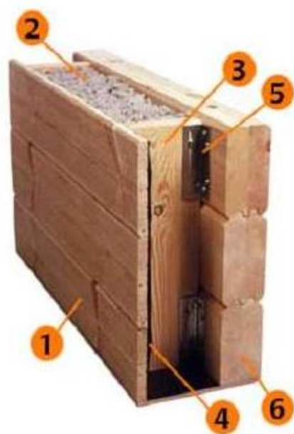
Stenová štruktúra s interiérovou dodatočnou izoláciou
